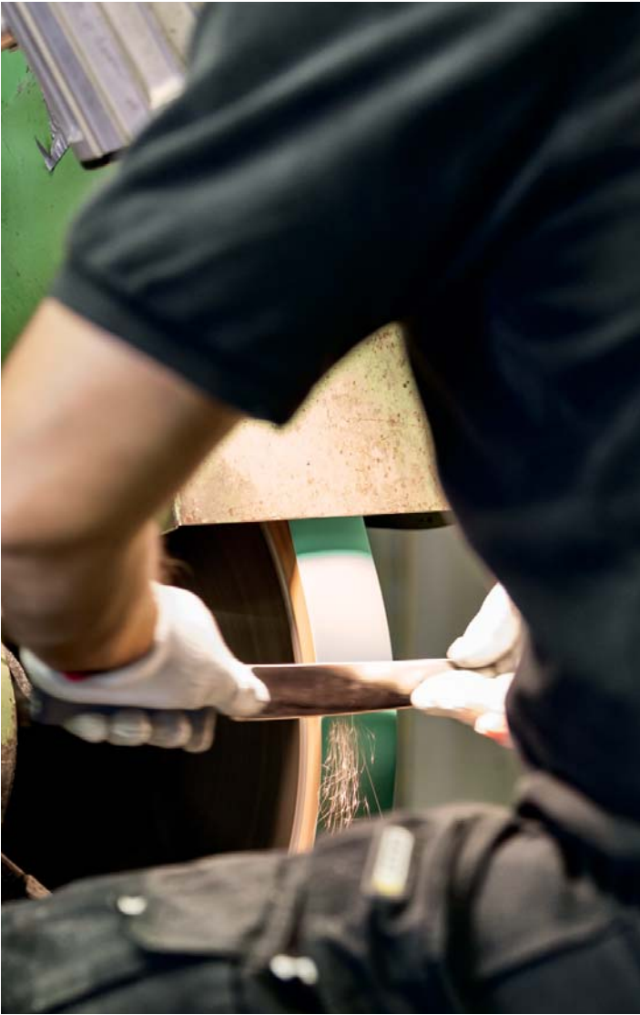
Etter at fagmannen for sluttsliping er ferdig med knivbladet, er det like skarpt som et barberblad
